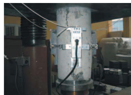
Tensometryczny czujnik przemieszczeń umieszczony na próbce zniszczonej
